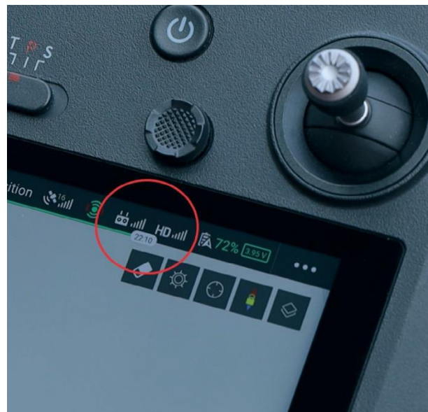
Figuur 3.10 - signaalsterkte indicatie op een zender van een drone (grondstation).
